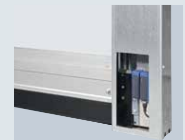
SC 1400 MP Machine Protection Los sensores de seguridad de la puerta se abren únicamente cuando la máquina está detenida y la máquina solo está en operación cuando la puerta está cerrada.
